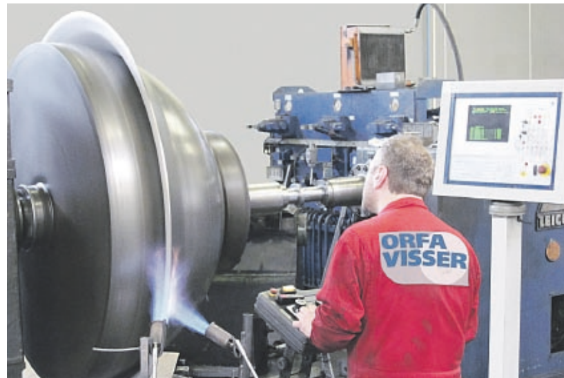
Na het lasersnijden van de rondellen, zijn de de platen door Orfa Visser geforceerd tot halve bollen.
