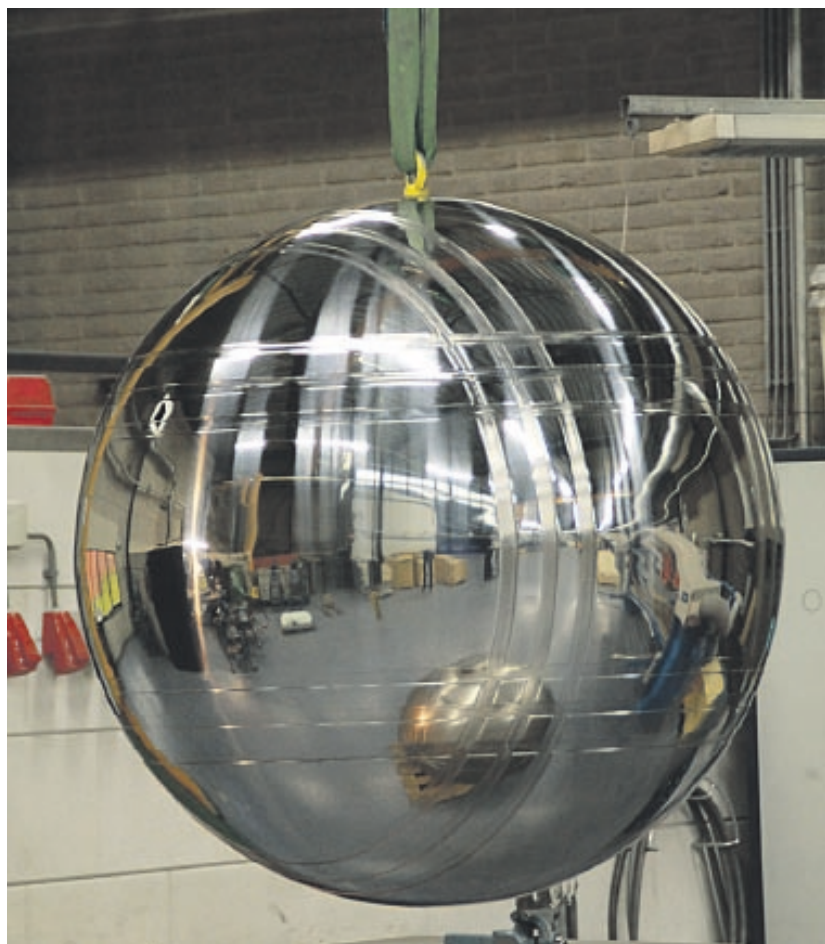
Breman Machinery heeft de groeven in de ballen gefreesd, variërend van één, twee tot zelfs drie groeven.
