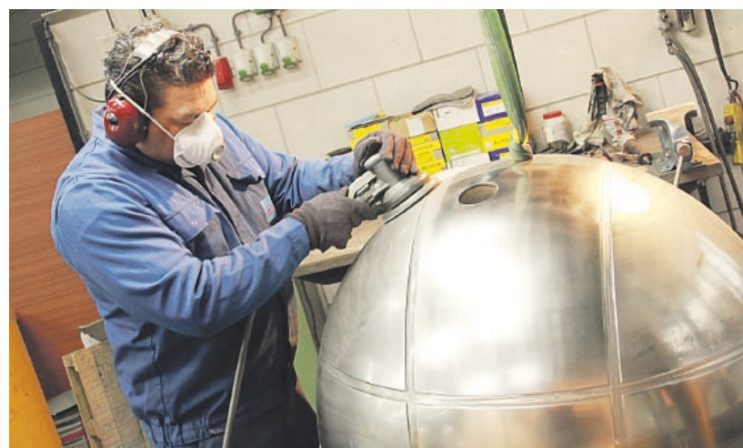
De laatste stap is het glimmend polijsten van de petanqueballen door Van Geenen,
